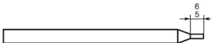
Рисунок 2 - Схематическое изображение карандаша после заточки
